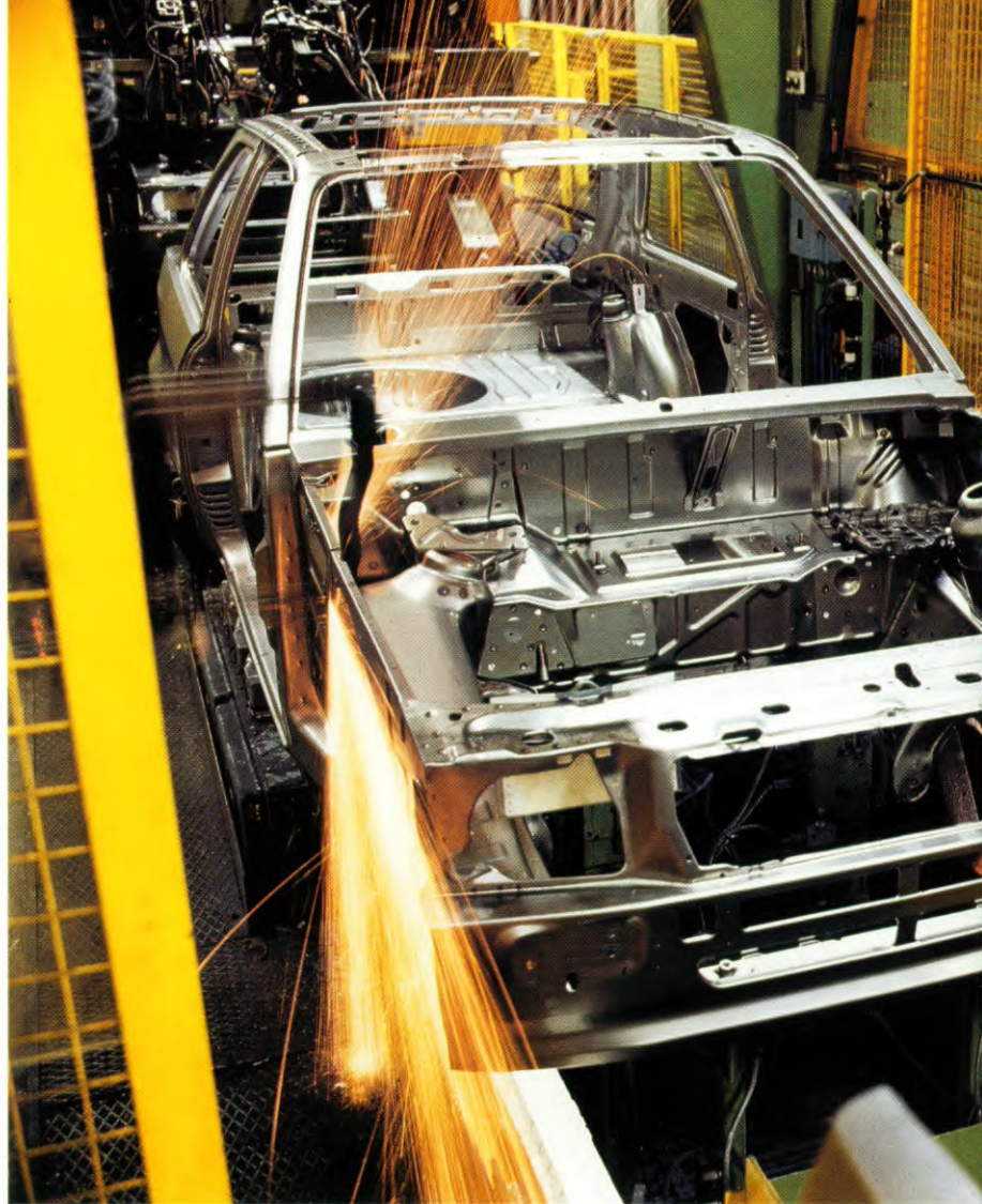
Lasrobotten zijn zo geprogrammeerd dat zij aan de hoogste normen voldoen.
