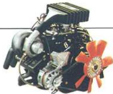
Wenn es sein muß, beim Überholen zum Beispiel, geht's natürlich äußerst flott voran. Übergangslos beschleunigt der Capri **turbo** bis zur Höchstgeschwindigkeit von ca. 215 km/h. Das alles verdankt er dem ungemein kraftvollen 2,8 Liter V6-Motor, der mit Turbolader, Sportauspuffanlage und kontaktloser Transistorzündung 138 kW (188 PS) bei 5.500 1/min leistet.
