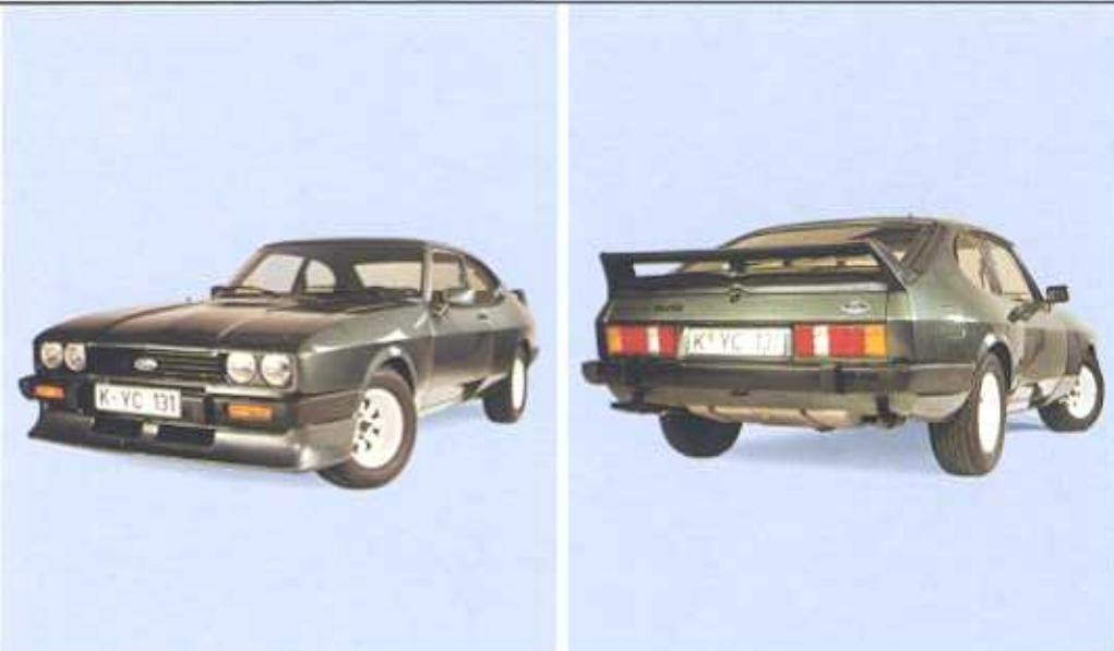
So stark wie er ist, so sieht er auch aus. Die Kotflügelverbreiterungen decken die dicken Räder ab und der große Frontspoiler sowie der Heckflügel dienen der besseren Straßenlage und somit auch der Sicherheit dieses Autos.
