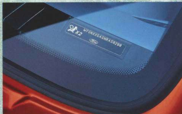
La placa de identificación del coche, VIN, está situada en un lugar visible para evitar robos.
