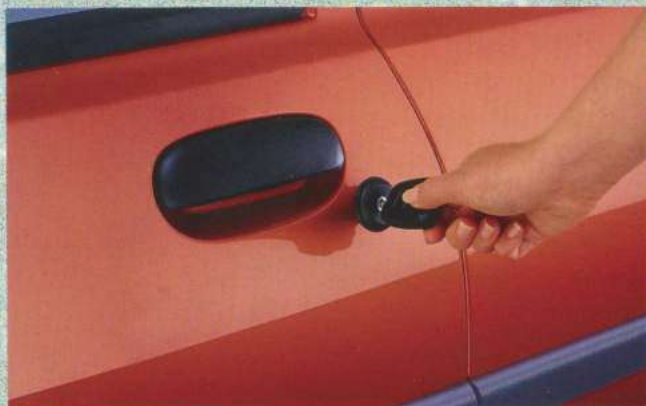
La seguridad del doble cierre impide la apertura de las puertas incluso si se rompiese la ventanilla.
