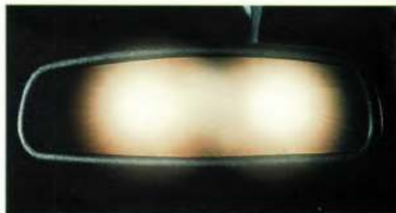
De zelfdimmende achteruitkijkspiegel stelt automatisch bij om verblinding te voorkomen door felle verlichting van achteropkomende auto's.
