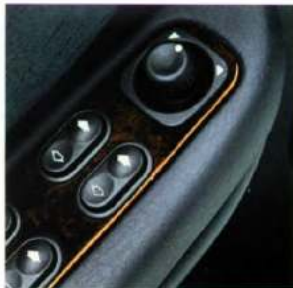
Door Multiplex is er aanzienlijk minder bedrading nodig. Doordachte positionering van de modules maakt het mogelijk de schakelaars overzichtelijker te plaatsen.
