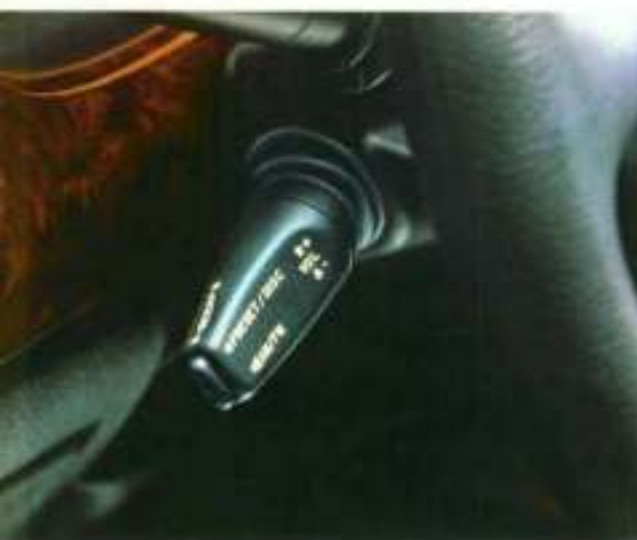
De afstandsbediening voor het audiosysteem, met een hendel aan de stuurkolom.
