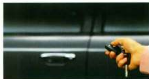
De radiobestuurde afstandsbediening van de Scorpio, ingebouwd in een handzame sleutelhanger, functioneert in een straal van tien meter rondom de auto.
