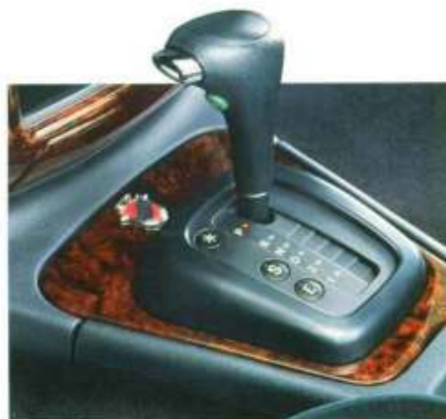
De nieuwe automatische transmissie A4LDE (niet op 2,9 V6 12V) biedt de keuze uit drie schakelprogramma's: Sport, Economy en Winter.
