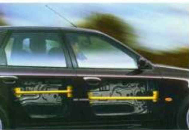
Stevige stalen balken zijn ingebouwd in alle portieren.
