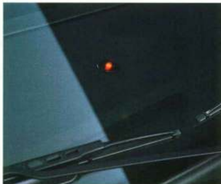
Het Perimeter Alarm wordt geactiveerd indien iemand probeert de portieren, de achterklep of de motorkap te forceren, of indien wordt geprobeerd het audiosysteem te verwijderen.
