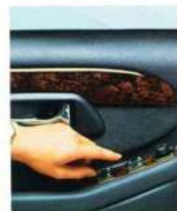
De elektrische raambebeding heeft standaard een 'one-touch-down' functie aan de bestuurderszijde.
