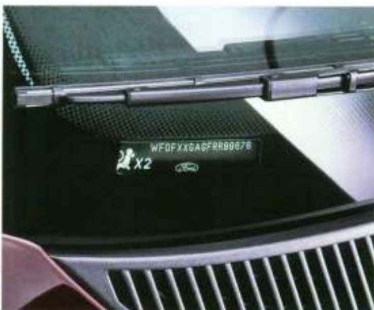
Het duidelijk zichtbare Voertuig Identificatie Nummer (VIN) onder de voormut werkt preventief tegen auto-diefstal.
