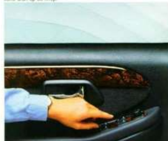
Indien uitgerust met de 'one-touch-down' functie kunnen de elektrisch bedienbare zijruiten volledig worden geopend met slechts één korte druk op de knop.
