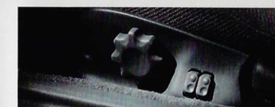
Oben: Kreuzstütze und Seitenpolster des Fahrersitzes, welcher über eine Memory-Funktion verfügt, lassen sich elektrisch verstellen.
