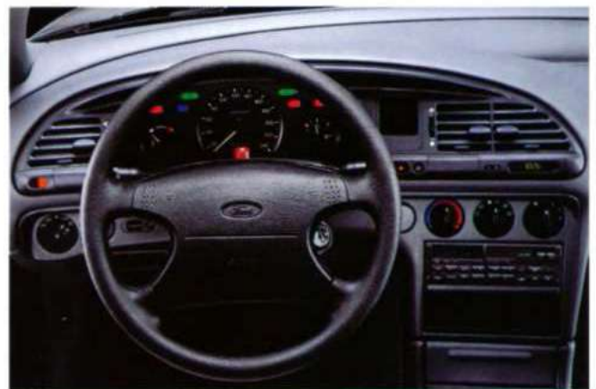
Het Mondeo instrumentenpaneel omvat een centraal geplaatste snelheidsmeter en een uitgebreid aantal andere meters. Stuurbekrachtiging is standaard en de stuurkolom is volledig verstelbaar.
