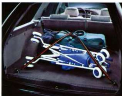
Sjor-ogen in de laadruimte om de lading vast te kunnen zetten, bieden bescherming aan bagage en inzittenden.
