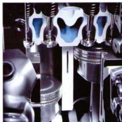
Lichtgewicht aluminium zuigers met lage-wrijvings-zuigerveren verminderen de slijtage van de cilinderwanden.
