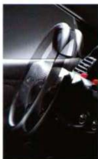
In lengte en hoogte verstelbare stuurkolom (standaard in alle versies).
