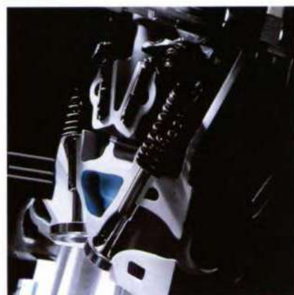
Vier kleppen per cilinder combineren een hoog vermogen met veel trekkracht bij lage toeren.
