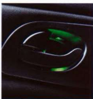
Verlichte portiergrepen worden als optie geleverd in combinatie met de op afstand bedienbare centrale dubbele portiervergrendeling (op Ghia, Si, GLX, GT, CLX).
