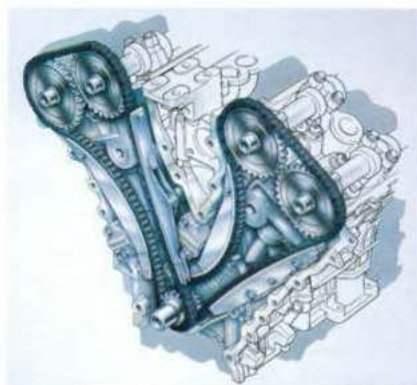
Automatische hydraulische kettingspanners houden de kleptiming accuraat en verlagen de geluid-sproductie.
