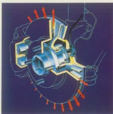
Abbildung rechts: Innenbelüftete Scheiben- bremse mit ABS-Sensor.
