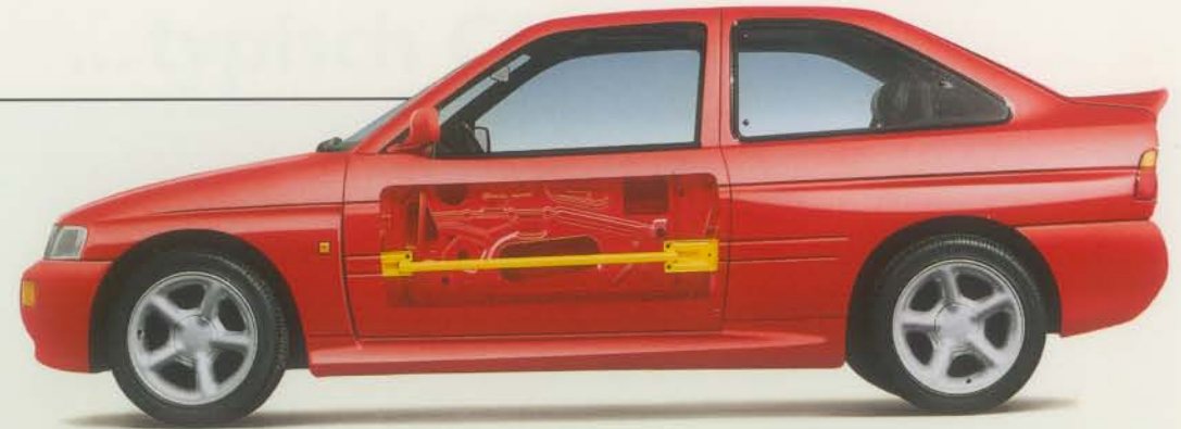
Hohe Sicherheit im Falle eines Aufpralls bietet die in die Seitentüren integrierte Stahlrohrkonstruktion.
