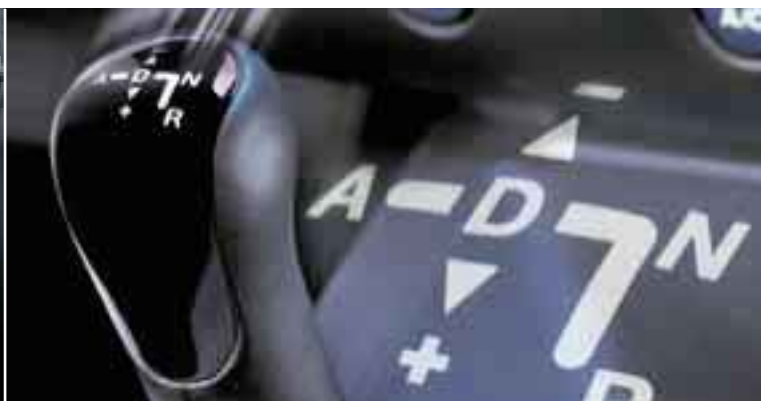
Cambio robotizzato Durashift EST* Progettato per combinare l'economicità di un cambio manuale a 5 marce con la comodità di un automatico, offre la possibilità di scegliere tra una modalità sequenziale senza frizione, con caratteristiche prettamente sportive, e una modalità di innesti delle marce totalmente automatici.
