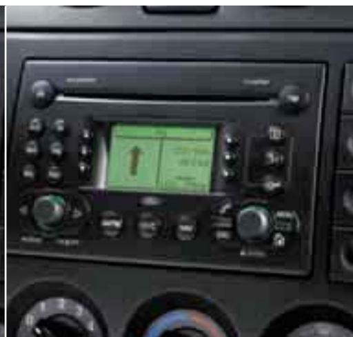
Impianto di navigazione satellitare Il sistema di navigazione satellitare TravelPilot (disponibile a richiesta) comprende radio, lettore CD e sistema di navigazione per condurti a destinazione con indicazioni vocali e visive.
