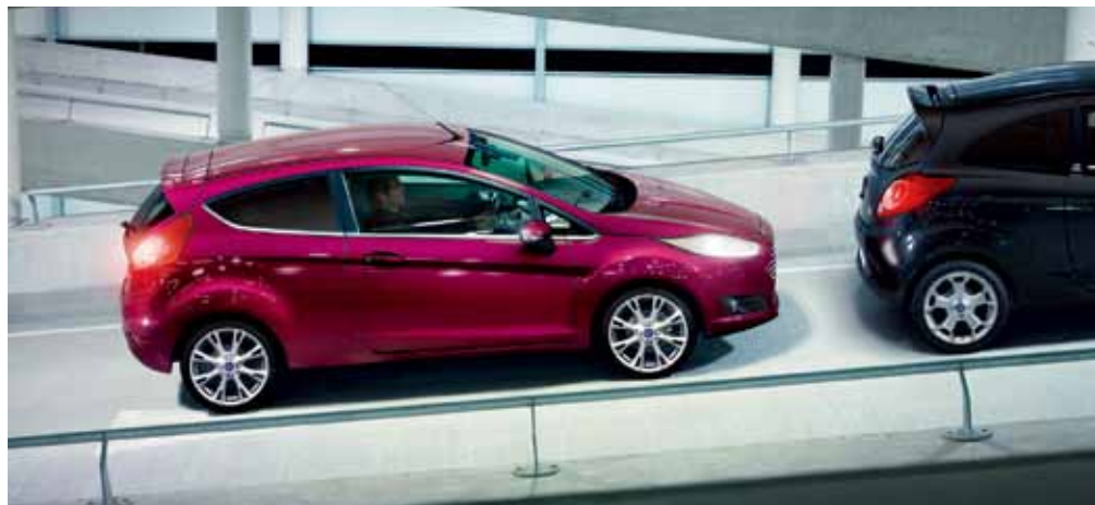
ヒルスタート・アシストは上り坂での発進、下り坂での後退時にブレーキペダルから足を放してから数秒間ブレーキを作動させて、不意の後退・前進を防ぐ機能。
