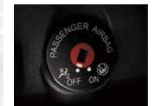
助手席エアバッグのキャンセルスイッチ。
