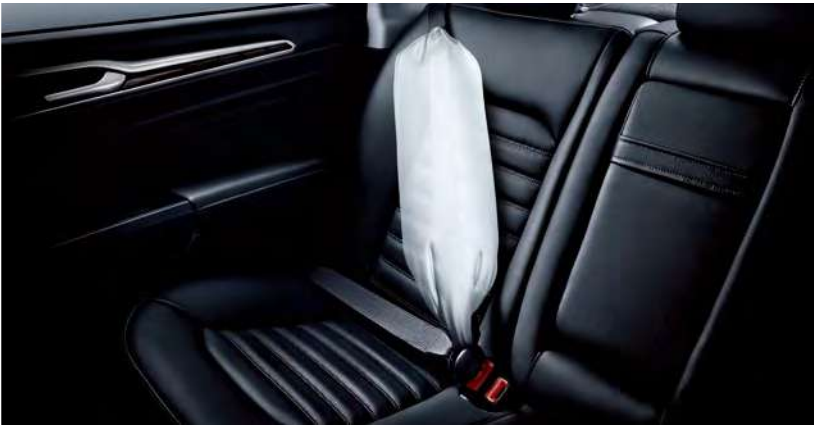
划时代的革新:后排气囊安全带 特别配备福特专利的带气囊安全带, 再次提升后排乘客的安全。碰撞发生时, 安全带迅速充气, 起到保护作用。
