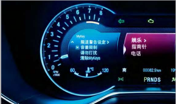
同级独有 MyKey 我的智能钥匙, 个性化设置行车参数 车主如需把车交付给特定驾驶者, 可通过MyKey预设最高时速、音响声量、ESC安全系统等, 车启动后将自动加载预设信息, 以此来保证行车的安全性。
