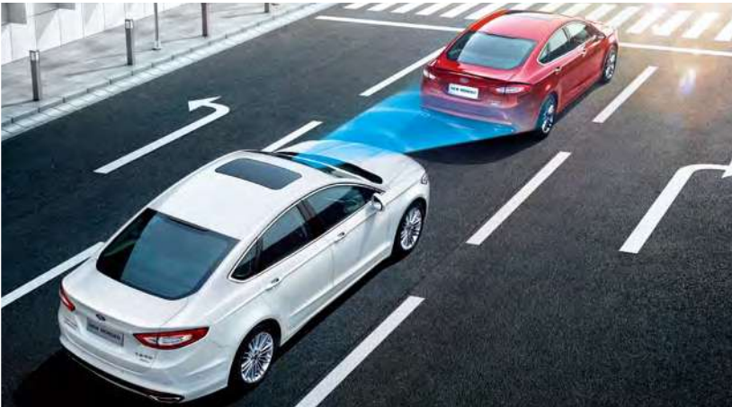
针对城市路况特别研发:ACS低速行车安全系统 当车速低于30公里/小时, 突遇前车紧急刹车, ACS将自动减缓速度进行制动, 减少事故发生。
