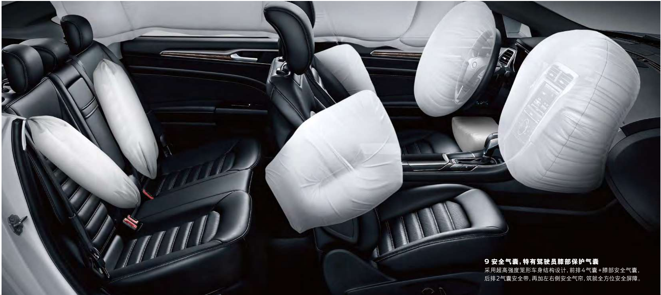
划时代的革新:后排气囊安全带 特别配备福特专利的带气囊安全带, 再次提升后排乘客的安全。碰撞发生时, 安全带迅速充气, 起到保护作用。
