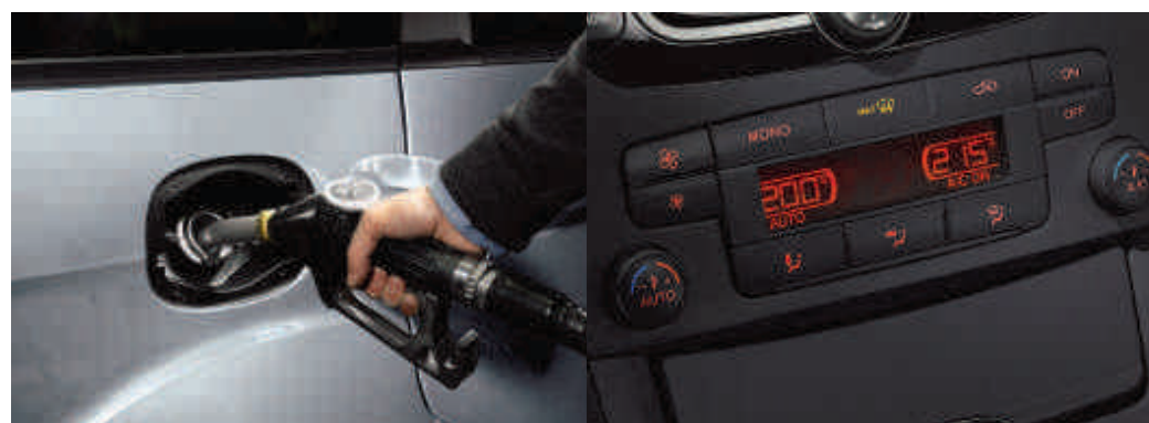
Ford Easy Fuel Komfort-Tankverschluss mit Fehlbetankungsschutz
