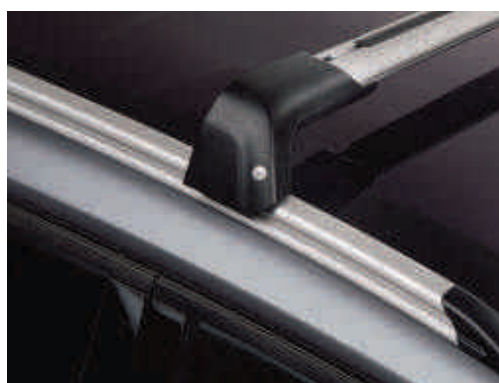
Dachleiste, eloxiertes Aluminium, mit verschiebbaren Querträgern (Querträger für Dachleiste sind Wunschausstattung)
