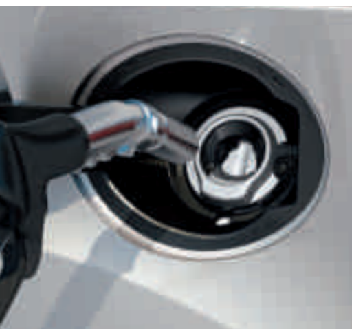
Trappe sans bouchon Ford Easy-Fuel avec détrompeur de carburant (Série)
