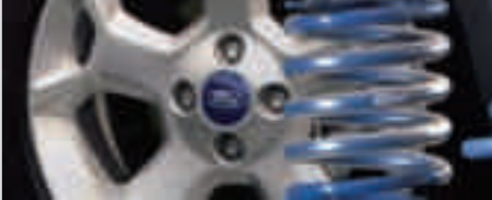
Kit de Suspensión rebajada Eibach Mejora el comportamiento de tu Ford Ka y la maniobrabilidad de la conducción mientras brinda una apariencia más deportiva. Disminuye la altura del vehículo en aproximadamente 30 mm. (Accesorio)
