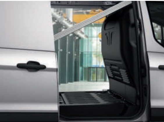
Mamparo de 203 x 101,5 mm Los modelos L2 Van pueden transportar hasta cuatro planchas de 203 x 101,5 mm apoyadas en un mamparo de acero concebido especialmente para ello. (De serie en Van)
