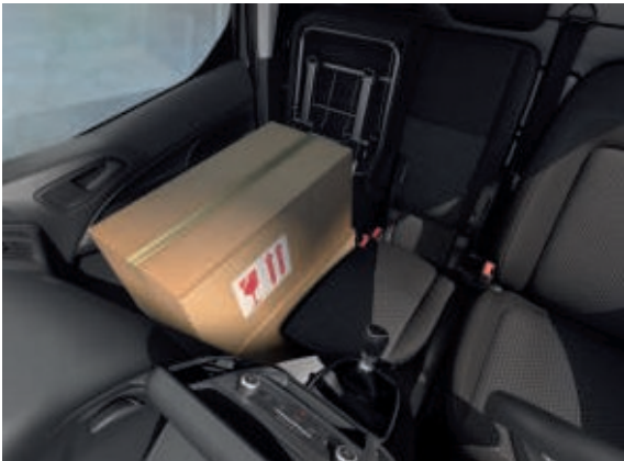
Asiento de pasajero con configuración flexible El asiento central es totalmente abatible, y la banqueta se puede levantar para revelar un compartimento portaobjetos. La base del asiento exterior se pliega como una butaca de cine para poder transportar objetos altos. (Opción)
