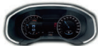
Un display especial muestra la potencia distribuida entre las 4 ruedas (estándar para todos los vehículos con tracción en las cuatro ruedas)
