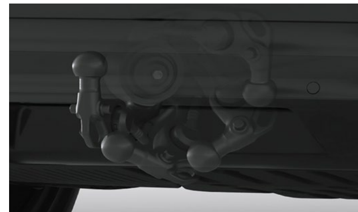
HAK HOLOWNICZY SKŁADANY ELEKTRYCZNIE Wyposażenie opcjonalne dla wszystkich wersji
