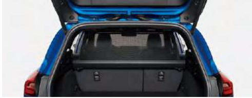
車內行李廂網狀隔網 ( WAGON 專屬 ) AMJX7J46046AB * 可防止行李物品在行駛時滑入後座乘客位置
