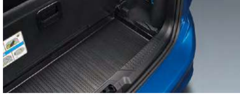
行李廂防水墊 ( WAGON 專屬 ) AMJX7JN454A14AA * 貼合車輛內部，保護車輛地板免受液體洩漏 * 由堅固且耐高溫的材料 (TPE) 製成，清洗簡易 * 無味、揮發極低，不含 PVC 等有害物質
