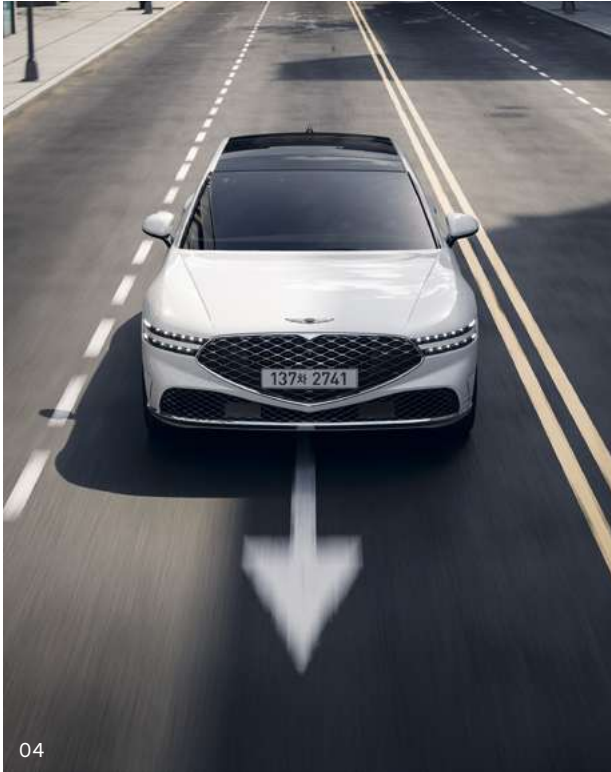
04. 차로 이탈방지 보조 _ 주행 시 방향지시등 스위치의 조작 없이 차로 이탈이 감지되면 경고를 보내고, 차로를 이탈하지 않도록 자동으로 조향을 도와줍니다. 차로 유지 보조 _ 차로 중앙을 유지하며 주행하도록 도와줍니다.
