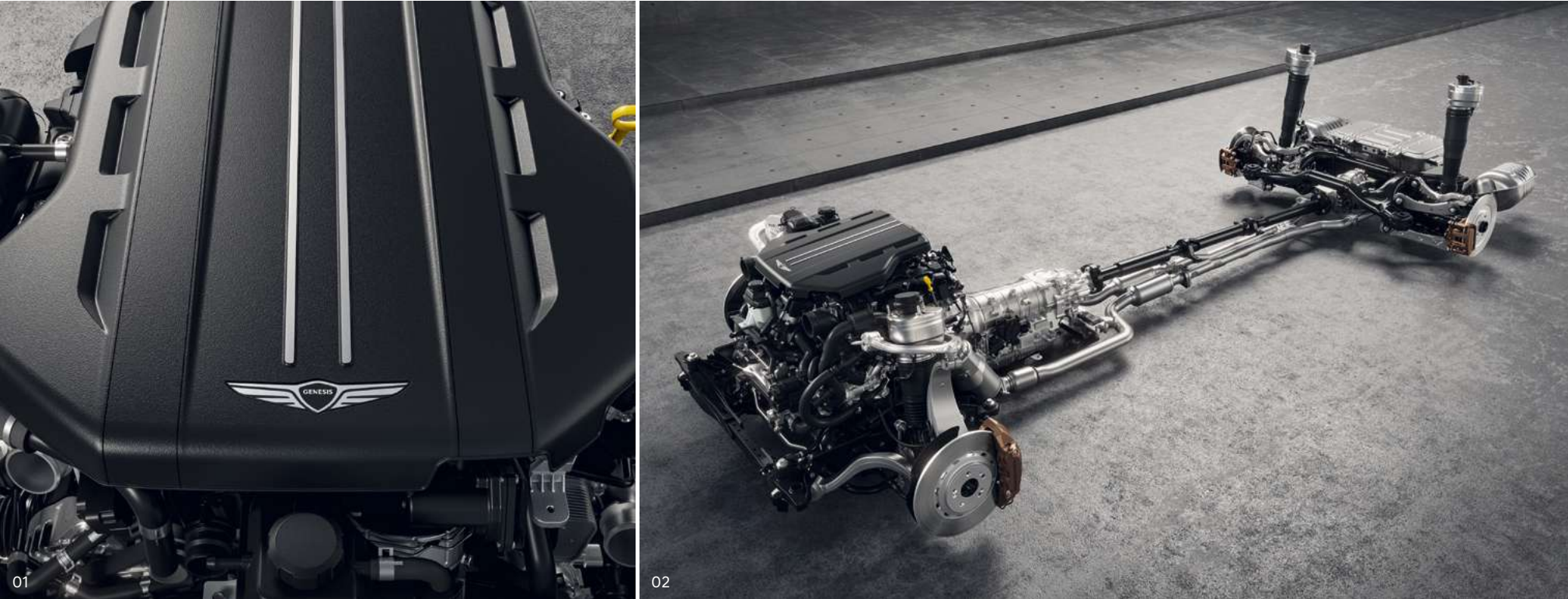
01. 가솔린 3.5 터보 엔진 _ 안정된 출력과 토크로 다이내믹한 주행감을 발휘하며, 센터 인젝션과 수냉식 인터쿨러가 개선된 연비와 빠른 응답성을 제공합니다. 02. 가솔린 3.5 터보 48V 일렉트릭 슈퍼차저 _ 전동 슈퍼차저를 적용한 수냉식 인터쿨러 시스템으로 저중속 성능을 높이고, 회생제동을 통한 충전과 토크 보조에 따른 응답성 개선으로 어떤 주행 환경에서도 최적의 성능을 구현합니다.
