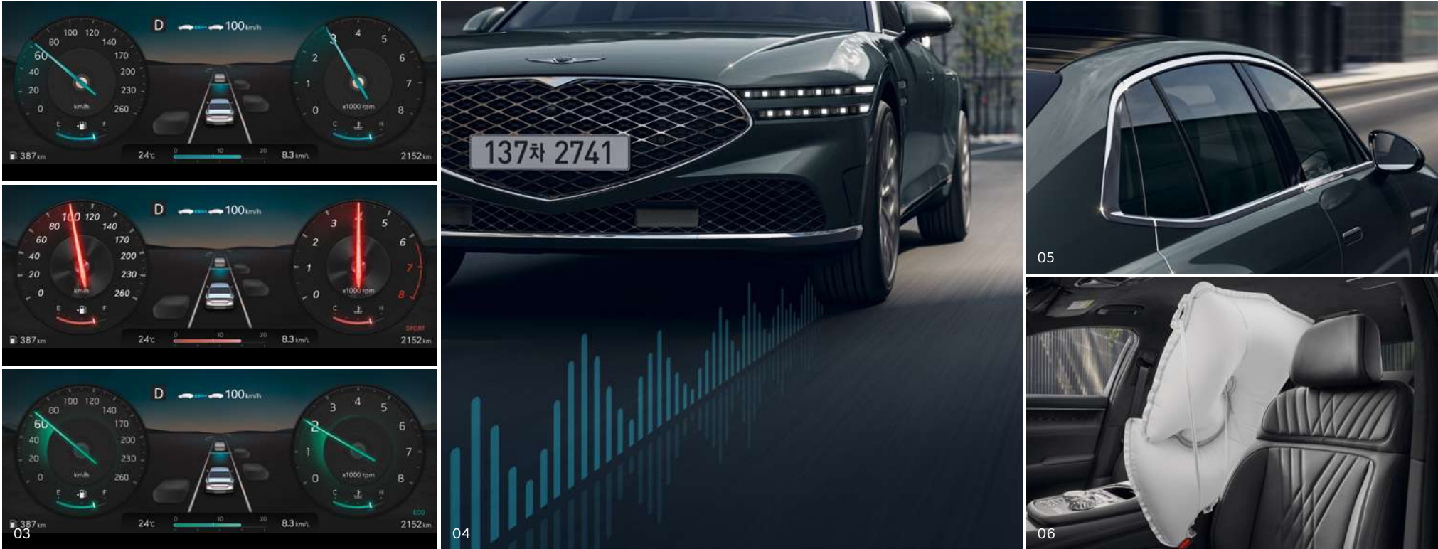
03. 통합 주행 모드 _ 운전자의 취향이나 도로 여건에 따라 콤포트, 스포츠, 에코, 커스텀 모드를 선택할 수 있습니다. 부드러운 승차감을 위한 콤포트 모드와 가속 성능을 위한 스포츠 모드, 연비 위주의 에코 모드를 통해 설정에 맞는 최적의 주행 감성을 전달합니다. 04. 액티브 노이즈 컨트롤 - 로드(ANC-R) _ 주행 중 발생하는 로드 노이즈가 실내로 전달될 경우, 소음과 반대되는 위상의 제어음을 출력해 소음을 저감하고 실내 정속성을 높입니다.
