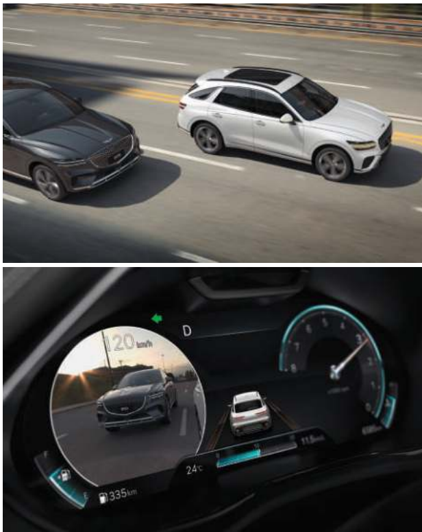
盲区防止碰撞辅助 转向灯开启准备变道时，后侧方有变更车道等来车情况下，预警碰撞危险，给予驾驶员警告。警告后如继续有碰撞危险时，辅助车辆制动，避免发生碰撞。
