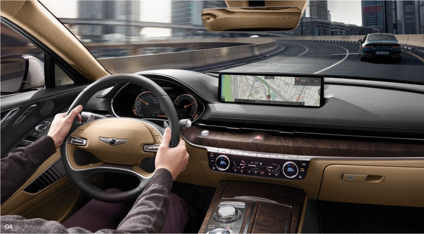
04. 내비게이션 기반 스마트 크루즈 컨트롤 _ 고속도로 주행 시 도로 상황에 맞춰 안전한 속도로 주행하도록 도와줍니다. 안전속도 구간 및 곡선 구간에서는 진입 전에 자동으로 감속하고 해당 구간을 지나면 원래 설정한 속도로 복귀합니다.
