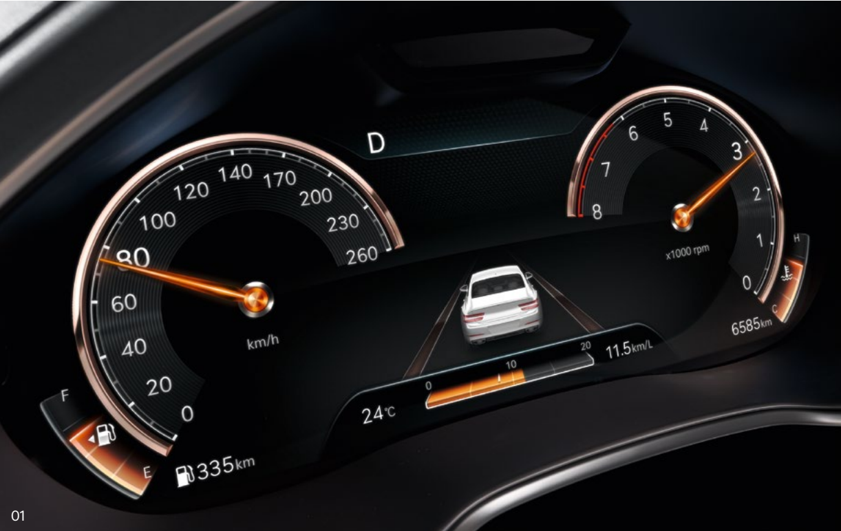
01. 12.3인치 3D 클러스터 _ 고해상도 대화면 TFT LCD 클러스터에는 주행모드에 따라 차별화된 디자인과 콘텐츠 뷰가 제공되며, 운전자는 어떤 각도에서도 3D로 입체감 있는 정보를 확인할 수 있습니다.
