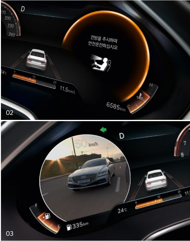
02. 03. 전방 주시 경고 _ 운전자가 전방을 주시하지 않는 상황으로 판단될 경우 경고로 알려줍니다. 후측방 모니터 _ 방향지시등 스위치를 조작하면 해당 방향의 후측방 영상이 클러스터에 표시됩니다.
