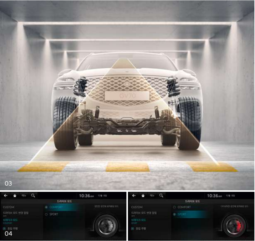
03. 프리뷰 전자제어 서스펜션 _ 전방 카메라를 통해 인식한 노면 정보와 내비게이션의 지도 정보를 바탕으로, 서스펜션의 감쇠력을 자동으로 조절하여 차량의 움직임을 제어합니다. 과속방지턱과 같이 차량에 큰 충격을 줄 수 있는 상황을 미리 인지하고 대응함으로써 부드럽고 편안한 승차감을 제공합니다.
