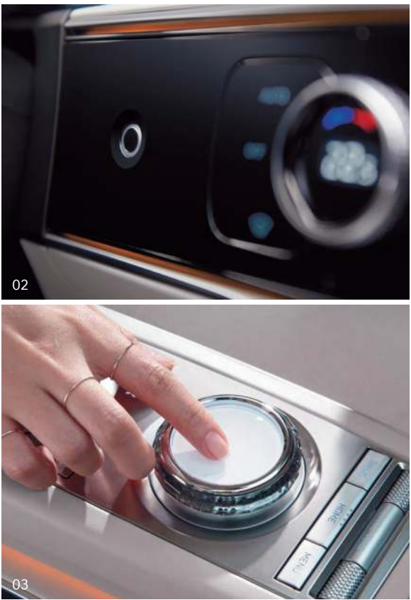
02. 03. 指纹识别系统_仅通过指纹认证即可启动车辆，可选择用户头像。 智能指尖交互系统_通过触控和书写方式操作信息娱乐系统的各种功能，提高用户的便利性和直观性。
