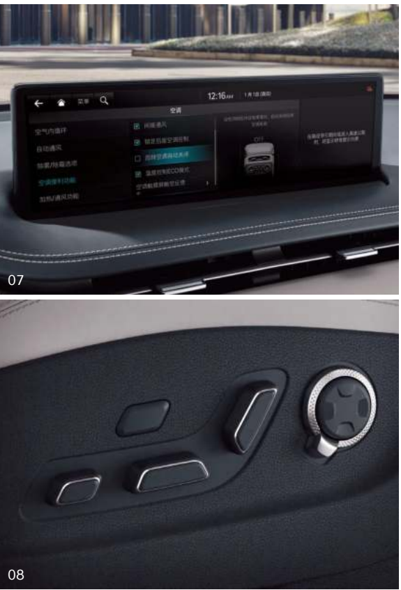
07. 08. 空调调节系统_熄火后干燥空调中残留的冷凝水、抑制霉菌增殖，从而减轻空调异味。 驾驶席&副驾驶席(ergo motion)座椅_座椅内部采用了独立控制的气囊，可保持最舒适的姿势。通过座椅垫部位的上下调节实现气垫支撑功能，以及根据行车情况调节靠背软垫部位的驾驶联动功能。
