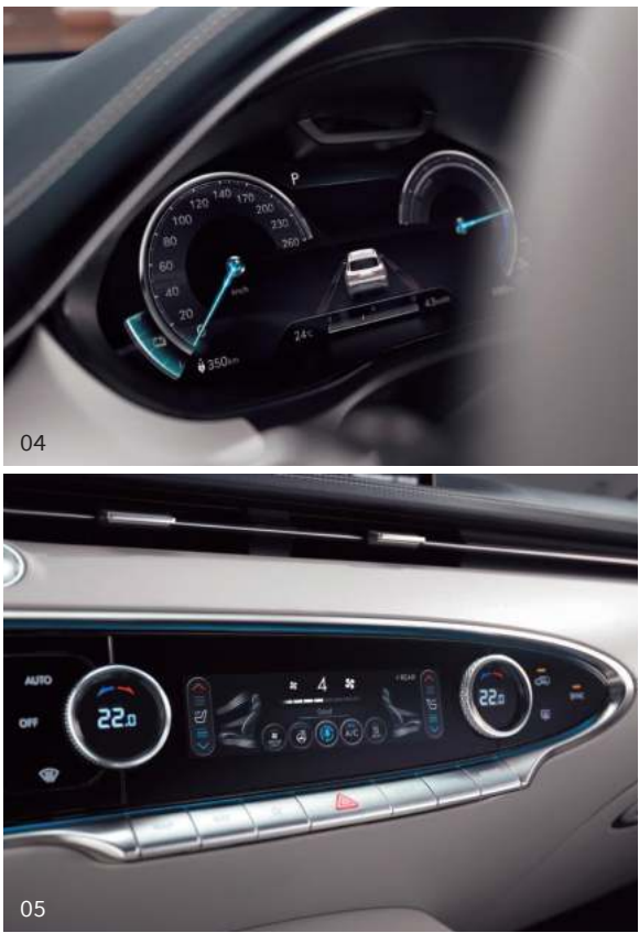
04. 05. 12.3英寸裸眼3D仪表盘_高清TFT LCD仪表盘随着驾驶模式变更显示不同的风格和内容。通过仪表盘上的摄像头追踪驾驶员的视线，在任何角度都可以裸眼识别3D影像。 三区独立自动空调_仅驾驶员搭乘时，为减少不必要的电耗，仅启动驾驶席侧面的空调。PM2.5传感器、高性能组合过滤器等空气清洁系统帮助保持舒适的车内空气。
