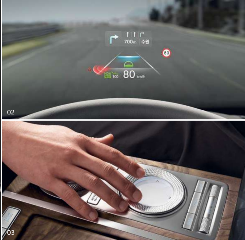
02. 헤드업 디스플레이 _ 주행속도, 내비게이션 정보 등은 물론, 운전자 보조 시스템의 주요 정보들과 갈림길 정보 등을 표시합니다. 12인치 와이드의 고화질 디스플레이로 주·야간 모두 시인성이 뛰어납니다. 03. 제네시스 통합 컨트롤러 _ 센터 콘솔에 위치한 통합 컨트롤러는 복잡하게 버튼을 누르거나 화면을 여러 번 터치할 필요 없이 다양한 인포테인먼트 시스템을 손쉽게 조작할 수 있도록 도와줍니다. 또한, 필기 인식 기능을 적용하여 키보드 입력 대신 손 글씨로 목적지 및 전화 번호부 검색 등을 간편하게 실행할 수 있습니다.
