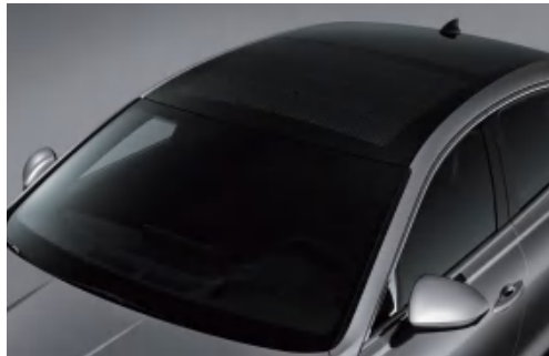
双层隔音玻璃(前挡风, 全车窗)
