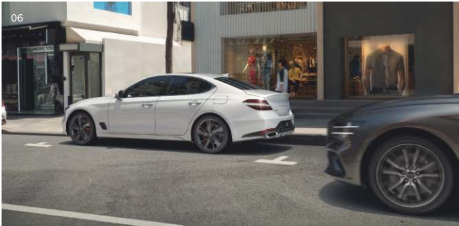
05 车道防止偏离辅助 在没有使用方向指示灯的情况下脱离车道时，发出警告并辅助调节方向盘。 06 安全下车警告 停车后，如果感应到有车辆从后侧方靠近，将发出警告。
