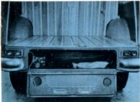
**Roue de secours** et outillage ont leur place dans un compartiment placé à l'arrière sous le plancher. La porte de ce compartiment est verrouillée à la fermeture des portes arrière.
