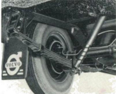
**Suspension arrière** avec ressorts à lames. Amortisseurs hydrauliques à double effet, inclinés vers l'intérieur de la voiture pour assurer une meilleure stabilité.
