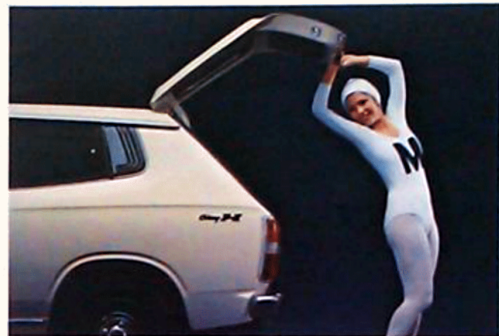
大きく開く1枚ハネ上げ式のリヤゲート。荷室開口部の大きさは横1050mm、タテ1200mm。荷室に見合ったワイド設計。開口高は1760mm。背の高い人にもムリな姿勢をしません。
