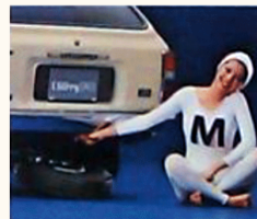
床下にセットされた吊下げ式のスペアタイヤ
