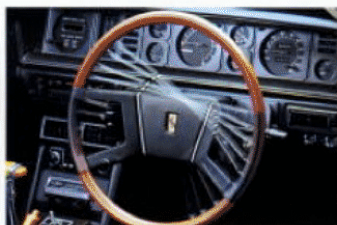
バーストレバー付サウンドコントロール エンジンの振動に反応してステアリングの重さも変化する2000GT専用のパワー・ステアリングです。高速走行時は、通常のステアリングのように重く、低速時には軽く切り、2輪入りの手回しでステアリングを調整可能に調整されることもありません。
