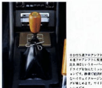
0.01付5速フロアシフト 4速フロアシフトに加速比0.882というスーパードライブを加えたミッションです。静粛で経済的なハイウェイクルージングが楽しめます。サイドブレーキです。
