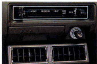
エアコンディショナー 4段調節だけでなく運転時に便利な除霜調節をそなえた4スピードタイプです。冷気の吹き出しはダッシュボード両サイドと、コンソールボックス上部の3カ所で室内の温度差の少ない涼風を送り、空気清浄機(デュアル)とあわせてお申しつけください。
