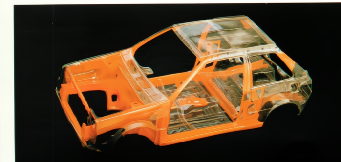
Verzinkt plaatstaal op de meest kwetsbare plaatsen.
