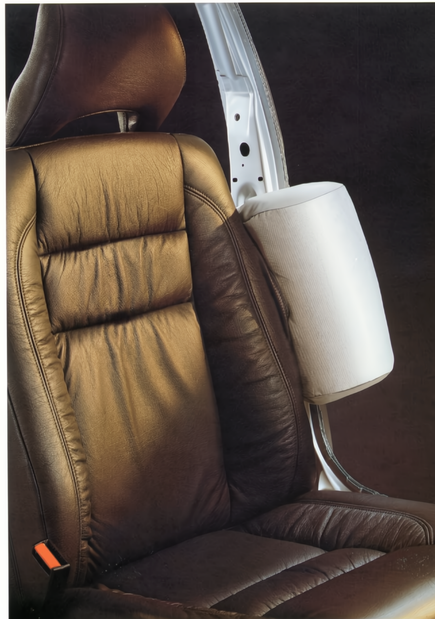
De SIPS-bag voor zijwaartse bescherming bevindt zich in de zijkant van de rugleuning van de voorstoel en niet in het portier. Hierdoor kunt ervan op aan dat de SIPS-bag steeds naast u is, zelfs als u de stoel in een ligstand geplaatst hebt.
