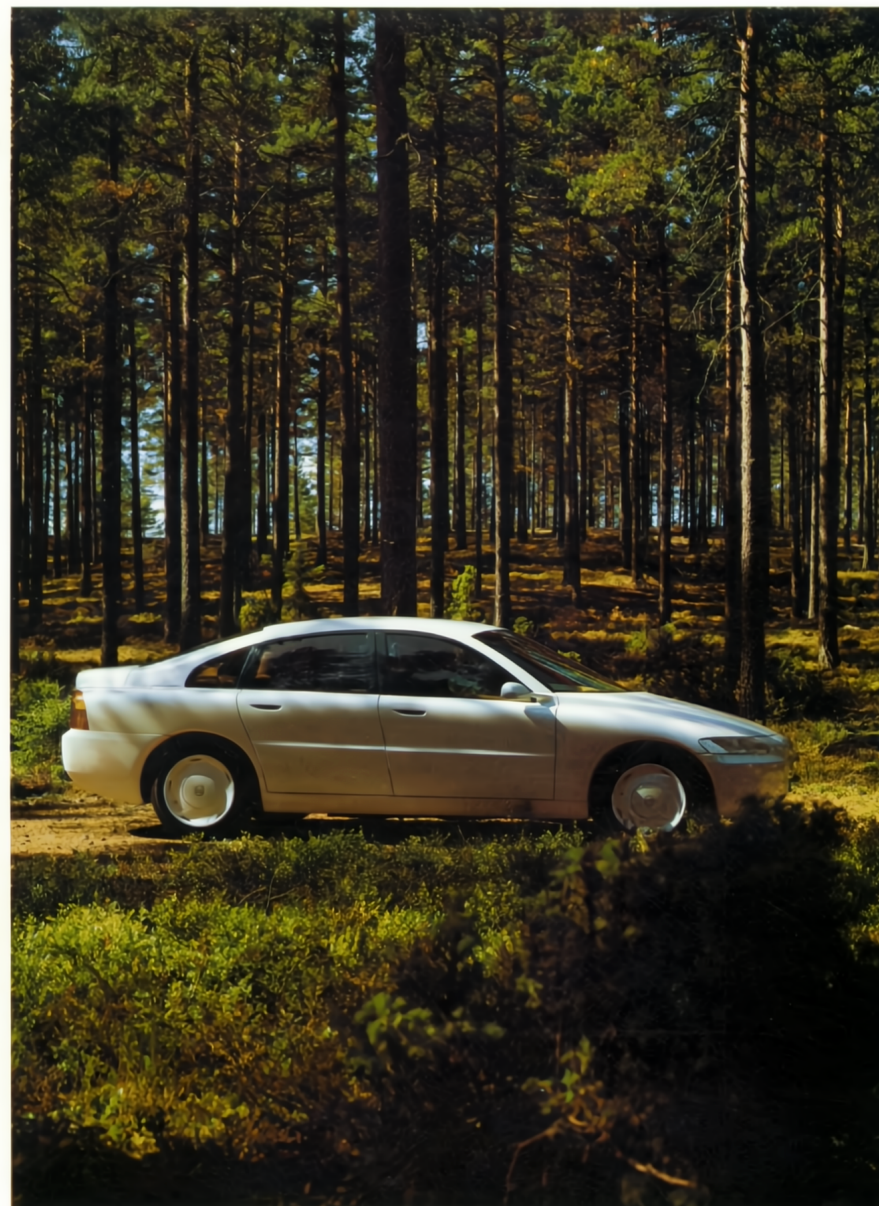
De Volvo ECC is het concept van een hybride milieuvriendelijke auto. Hij beschikt over een electromotor die door accu's wordt aangedreven, die op hun beurt weer worden opgeladen door een gasturbine aangedreven generator. Wanneer de auto stilstaat kunnen de accu's ook op het elektriciteitsnet worden aangesloten. In het stadsverkeer rijdt de auto alleen op electriciteit en tijdens langere ritten kan de gasturbine worden ingeschakeld om de accu's op te laden en voor extra vermogen te zorgen. Uitgaande van gemiddeld rijgedrag wordt de belasting voor het milieu gehalveerd t.o.v. een conventionele auto.
