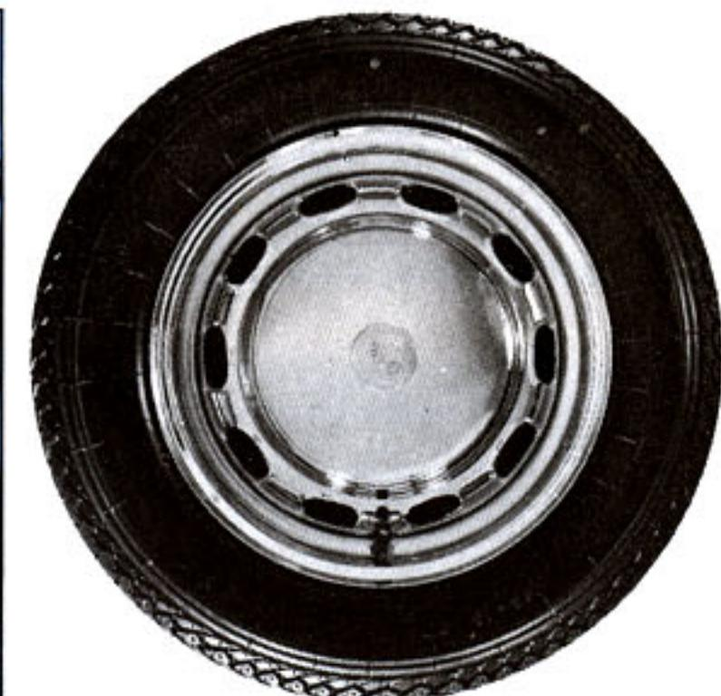
Charakteristisch für das äußere Bild des 911 S sind die geschmiedeten Leichtmetallfelgen. Ihr geringes Gewicht verbessert die Federungseigenschaften – die großen Luftöffnungen ermöglichen eine besonders intensive Belüftung der bei diesem leistungsstarken Fahrzeug härter beanspruchten Bremsen. Eine breite Leiste aus eloxiertem Leichtmetall unterhalb der Tür streckt das Fahrzeug optisch und verhindert Beschädigungen der Lackierung.
