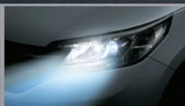
ไฟหน้าแบบ HID พร้อมระบบปรับระดับสูง-ต่ำอัตโนมัติ
