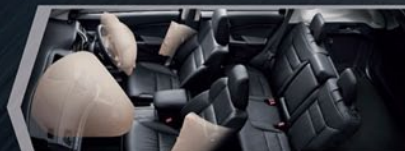
ถุงลมนิรภัย Dual SRS และถุงลมนิรภัยด้านข้างคู่หน้าอัจฉริยะ: I-Side Airbags
