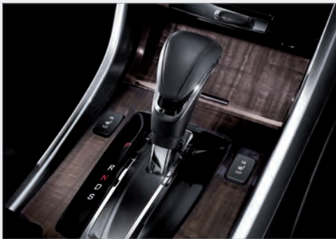
변속기 | 자동 6단 변속기는 경량화, 컴팩트화를 통해 동력전달을 최적화함으로써 성능과 연비를 동시에 개선하였습니다. 또한 직렬 4기통 엔진과 CVT의 결합은 폭발적인 성능과 민첩한 대응력의 환상적인 조화를 구현합니다. (3.5: 자동 6단 / 2.4: CVT)
