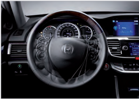
EPS (Electric Power Steering) | 랙 앤 피니언 구조에 전동 모터를 추가하여 스티어링 조작에 필요한 힘은 줄이고 조작감은 한층 향상시켰습니다. 정확하고 안정된 조향성능은 물론 연비향상에도 효과적입니다.
