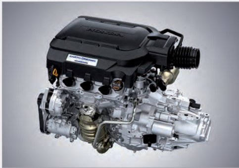
V형 6기통 SOHC i-VTEC 엔진 | 최고출력 282마력, 최대토크 34.8kg·m의 최적화된 높은 출력과 연비를 실현한 첨단 엔진은, 일정한 조건 하에서 실린더를 3기통, 6기통으로 가변 제어함으로써 엔진 효율을 증가시키는 VCM 시스템을 채용하였습니다.
