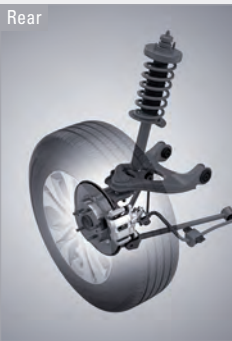
서스펜션 | 프론트는 맥퍼슨 스트럿, 리어는 멀티링크 서스펜션을 적용하여 안전성이 뛰어나고 고품질의 승차감을 실현하였습니다.
