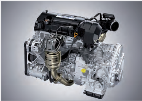
직렬 4기통 DOHC i-VTEC DI 엔진 | 최고출력 188마력, 최대토크 25.0kg·m를 실현한 직렬 4기통 DOHC i-VTEC DI 엔진은 연료를 직접 분사하여 강력한 파워 드라이빙의 즐거움은 물론, 연비향상, 배출가스를 저감한 친환경성까지 갖추었습니다.
