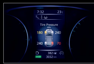
TIRE PRESSURE MONITORING SYSTEM 추측은 이제 그만. 각 타이어의 공기압이 운전석의 인포메이션 스크린에 표시되어 공기압이 낮은 경우 이를 알려줍니다.
