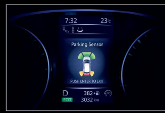
PARKING DISPLAY SENSORS 주차하는 동안 센서의 작동 정보를 확인할 수 있어 안전하게 주차할 수 있도록 도와줍니다.
