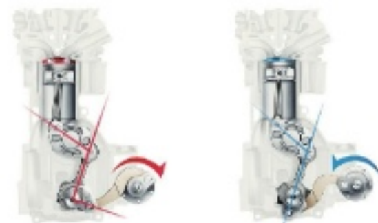
8:1(高性能) 压缩比智能无缝切换 14:1(高效率)
