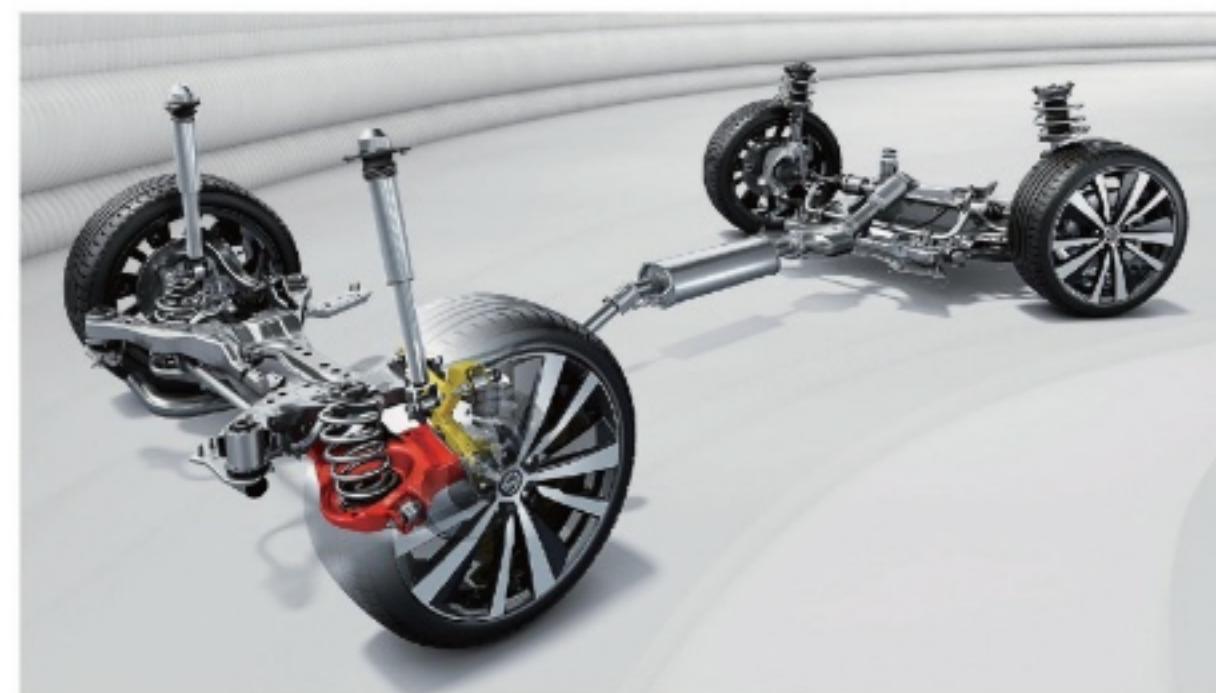
梯形控制臂多连杆式独立后悬挂(首次采用单筒减震器)
